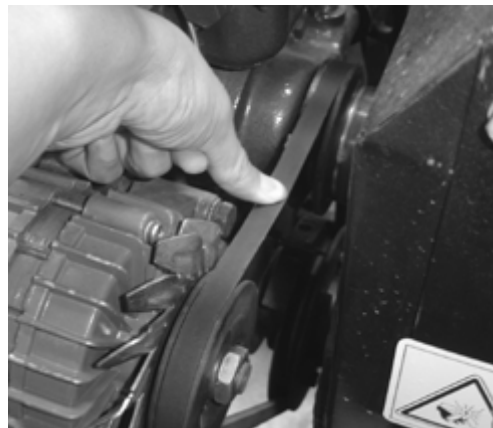
Мал. 5-21 Регулювання натягу гумової стрічки вентилятора
