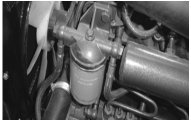
Мал.5-24уход і зміст паливного фільтра
