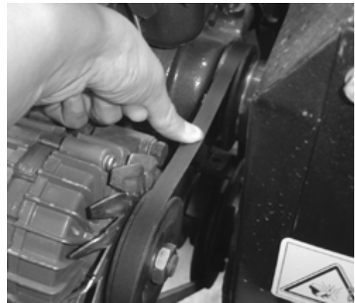
Мал. 5-21 Регулювання натягу гумової стрічки вентилятора
